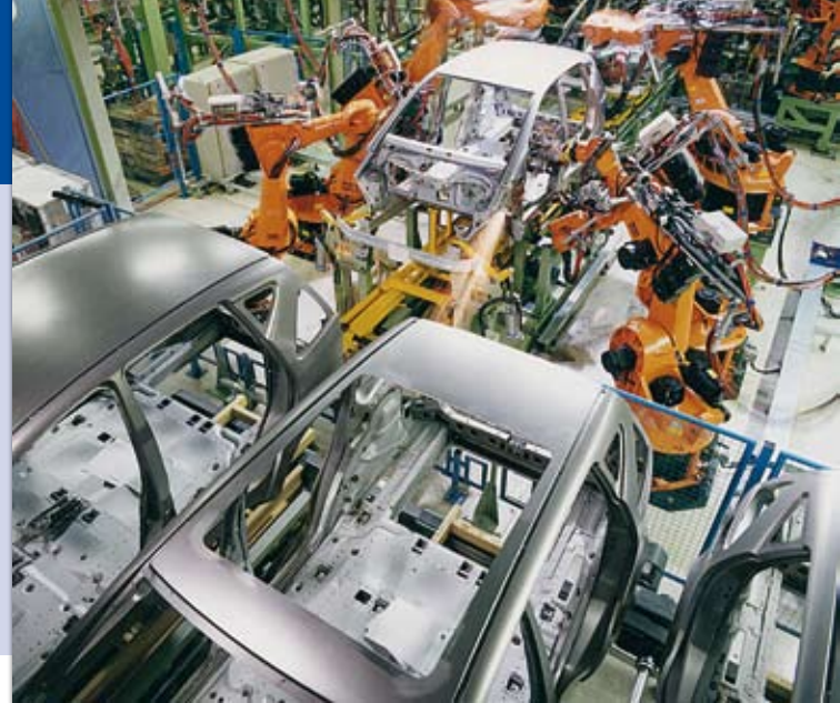
Ligne de ferrage de la Mercedes Classe A.
