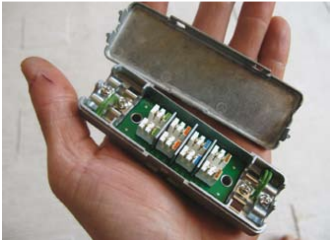
Rustine Gigabits Ethernet pour câbles endommagés, ce boîtier proposé par Weidmuller peut également servir à prolonger une liaison de façon définitive. (doc. ML)
