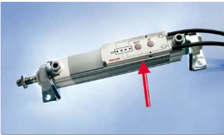
Les vérins pneumatiques commencent à intégrer la détection... et deviennent programmables en 2 ou 4 points, via un signal 0-10 V, 4-20 mA ou analogique. La mécatronique a encore frappé ! (doc. Rexroth)
