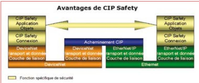
tectée, le dispositif est mis hors tension, état que l'on appelle généralement état de sécurité. Le code de sécurité de chaque dispositif est responsable de la détection de ces erreurs de communication. Il est exécuté dans une zone à haute intégrité du dispositif de sécurité, qui utilise en principe des équipements redondants homologués par un organisme de certification.
