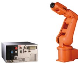
Nouveau robot IRB 120 et son armoire de commande IRC5 Compact
