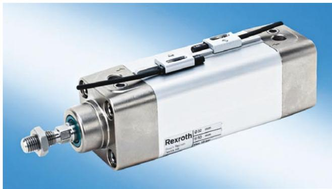
alimentaire NSF/USDA H1. Le fluide utilisé est de l'air comprimé selon le standard ISO 8573-1, classe 6, 4,3 ou inférieur. La plage de température d'utilisation est comprise entre -20°C et +70°C. La pression maximum de service de ces vérins est de 10 bars.
