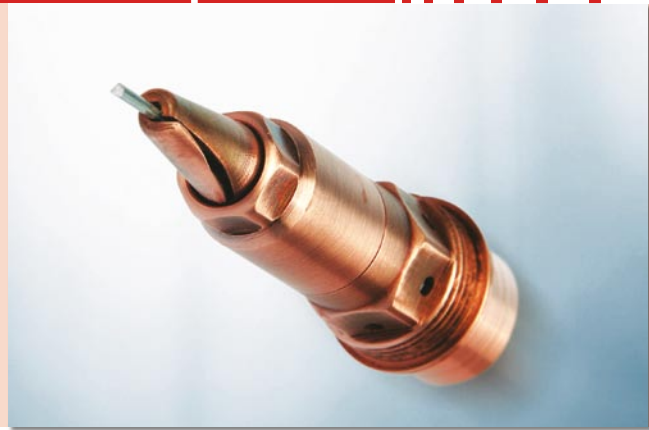
La technologie Contec de Fronius remplace le tube contact par deux demi-coquilles, qui assurent un contact constant avec le fil.
