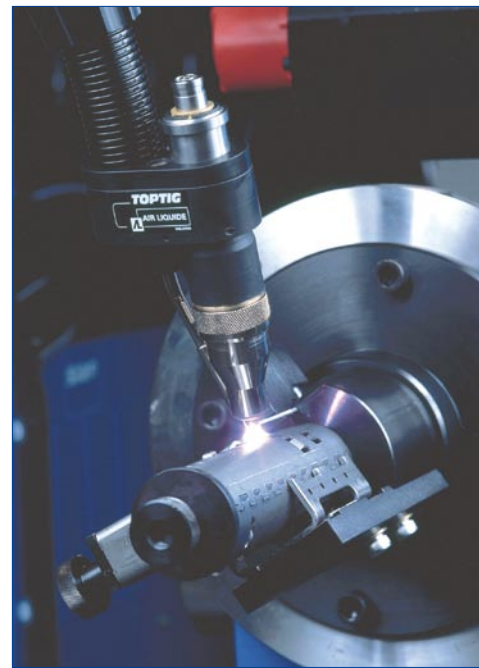
Avec son système d'amenée de fil intégré à la buse, la broche TopTig d'Air Liquide Welding concilie les avantages des procédés TIG et MIG/MAG.
