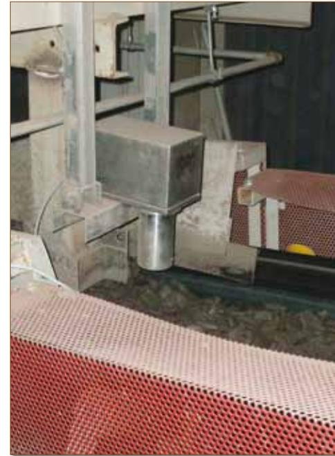
Dès la préparation de la terre, ce capteur d'humidité permet de réguler le dosage du mélange.
