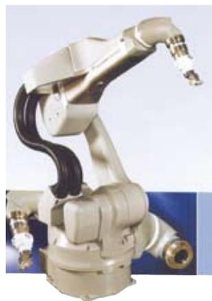
cœur de son métier, le soudage à l'arc, que Motoman montrait pour la première fois un robot à sept axes. Au premier abord, il ressemble à un robot de soudage classique, si ce n'est que son premier bras, situé entre l'axe 1 et l'axe 2, a été coupé en son milieu, un axe de rotation perpendiculaire au bras réunissant les deux parties.
