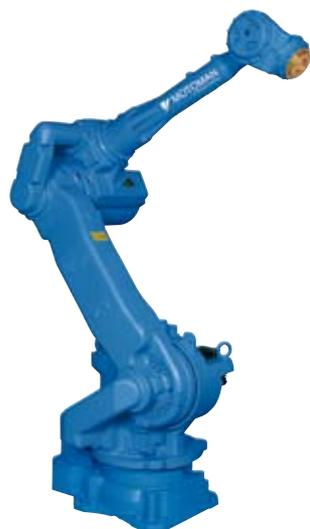
Côté performance, la précision est annoncée pour +/- 0,08 mm, le volume de travail pour 1.434 mm et la charge est limitée à 3 kilos.
