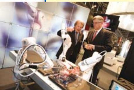
permettre de travailler main droite/main gauche que ce soit comme sur le salon pour déposer de la colle sur une pièce mécanique ou pour souder des pièces entre elles. Chaque bras pouvant manipuler jusqu'à 10 kilos de charge.
