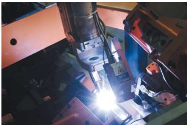
Suivi de joint avec capteur laser.
