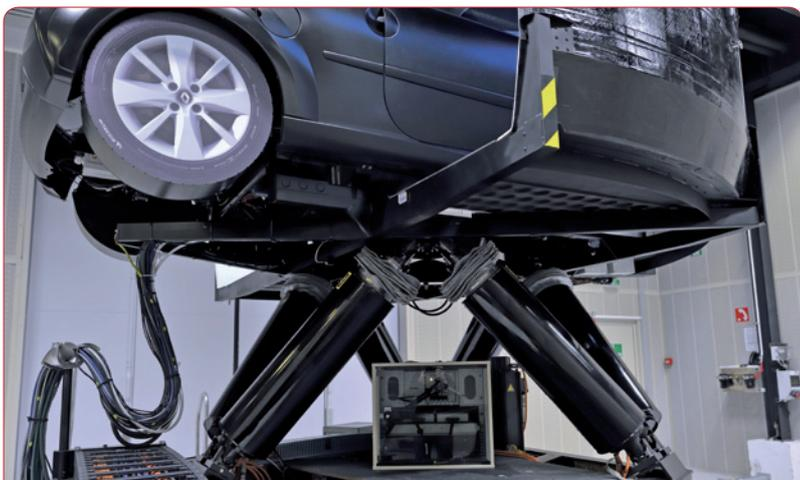
Outre le déplacement sur rails offrant 7 mètres de débattement sur les axes X et Y, un robot Bosch Rexroth à 6 vérins renforce le réalisme des mouvements.
