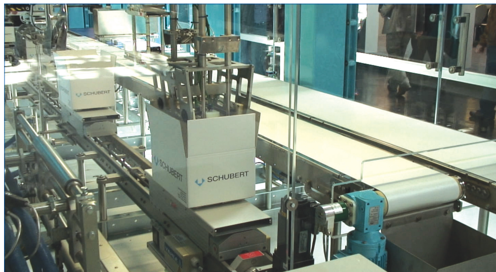
Cette année Schubert a mis au point un système de navettes indépendantes qui desservent chaque module de ses machines.
